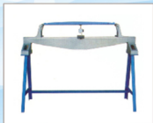
铁盖板蹀蹀面机测量平台
